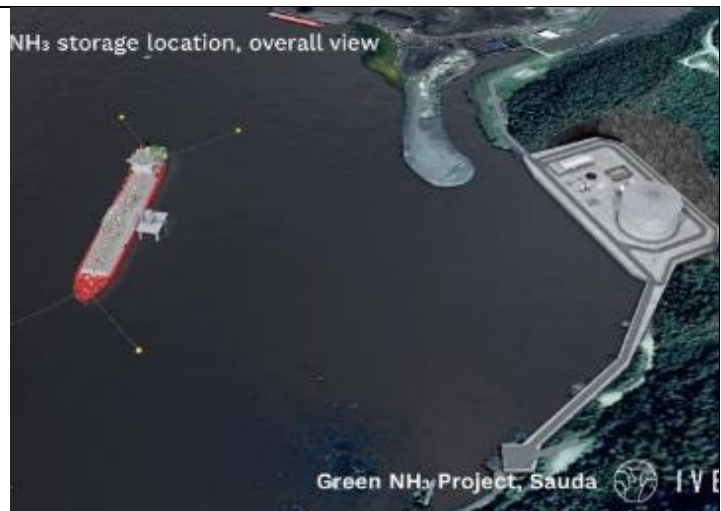
Figur 92: Ankret fartøy, eConnect (flytende «øy» med for fylling) på langsiden av skipet og tankanlegg med begge tilkomstveger, Kilde: Iverson eFuels, april 2023. Obs plassering er endret i planforslaget
