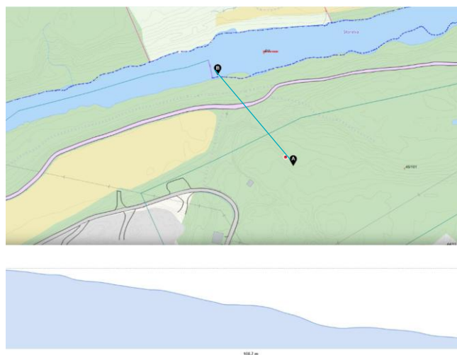
Figur 114: Beregning snitt vannføring/mengde og visualisering av trase med fall 10%, Norconsult AS, datert 15.11.2024
