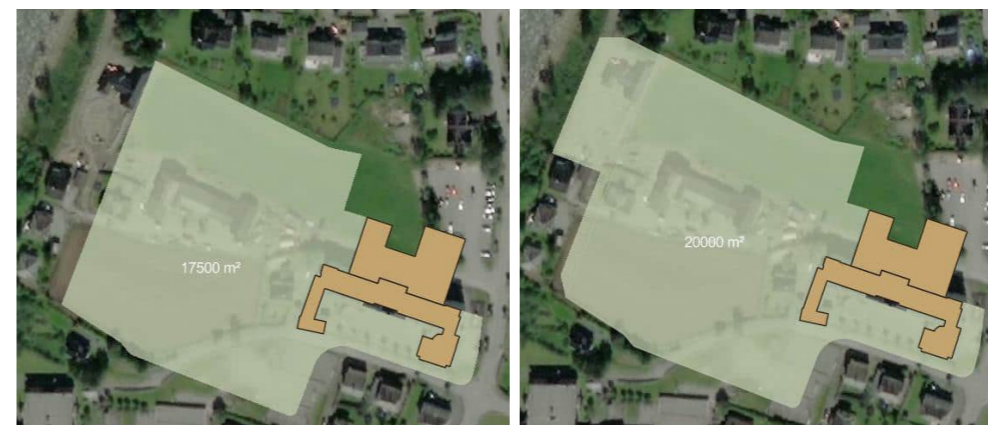
Figur 21 Illustrasjoner av utearealet på Fløgstad med henholdsvis 350 elever og 400 elever med 50m 2 per elev
