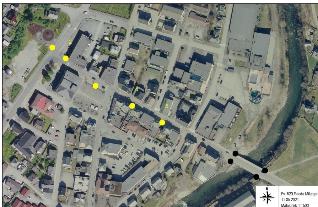
Figur 31: Oversiktskart som viser plassering av de utførte totalsonderinger for fv. 520 Sauda miljøgate (markert i gult), samt tidligere utførte undersøkelser for Nordelv bru i 2012 (markert i svart).
