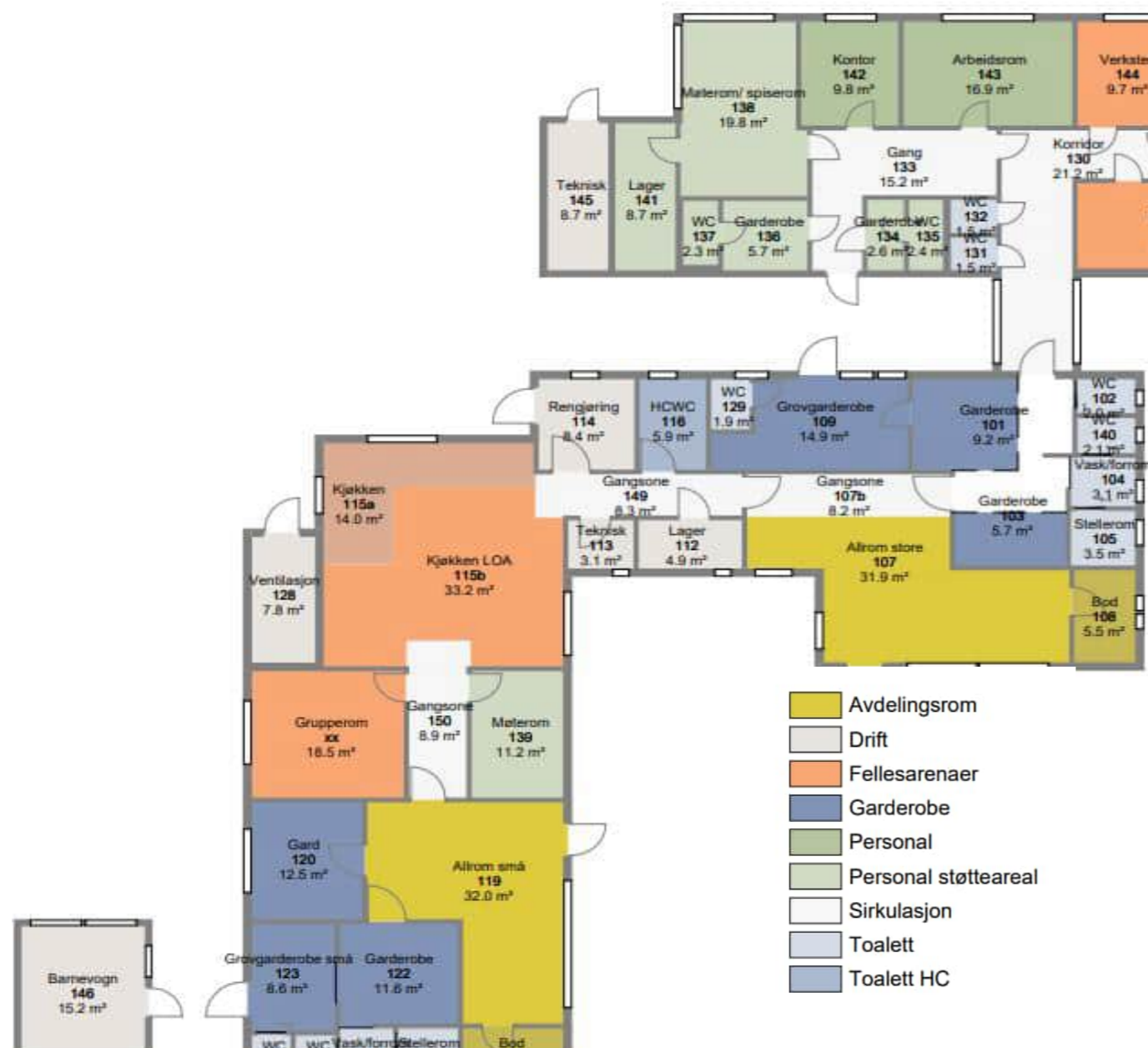
Figur 7 Ny planløsning for Rustå etter oppgradering
