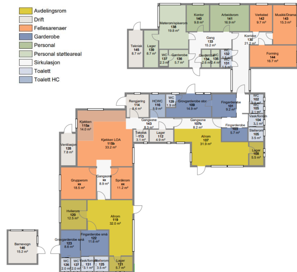
Figur 2: Plantegning Rustå barnehage med funksjoner
