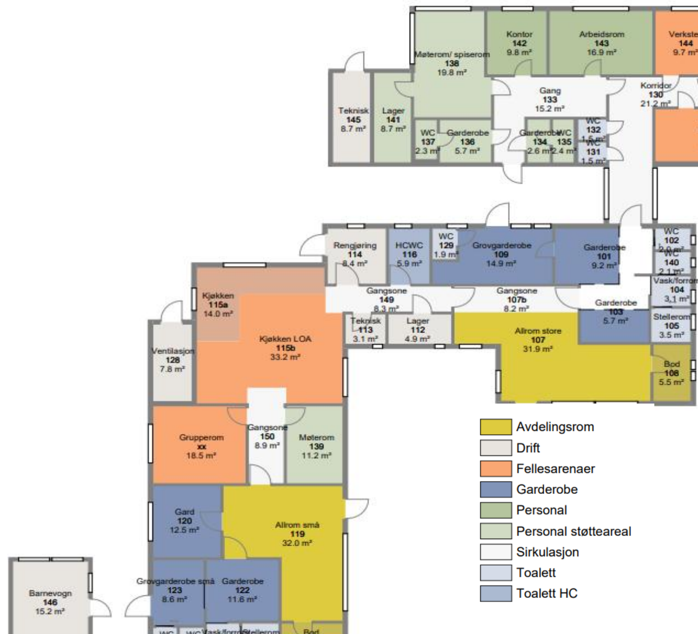
Figur 7 Ny planløsning for Rustå etter oppgradering
