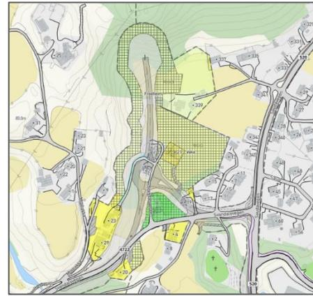
Figur 1-2: Ny veg, rundkøyring og kryss på Saudasida av tunnelen slik det er teikna i reguleringsplanen.
